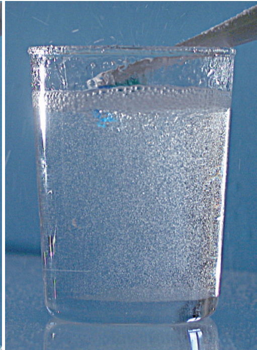
Abb. 7 Test einer hydrodynamisch wirksamen Schallzahnbürste. Luftblasen im ganzen Glas zeigen die erzeugte Strömung.
